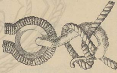
Σχῆμα 45. Ἀπλοῦς κοροκόδεσμος
